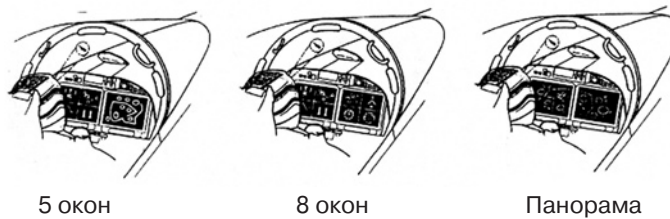
Рис. 2. Представление информации в панорамной кабине
